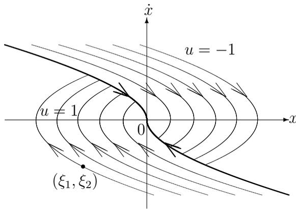
Поскольку всегда  $|\dot{x}_2| = 1$  на оптимальной траектории, то  $x_2 = \pm t + C$  и, значит, время движения  $\hat{T} = \text{Var } x_2$  (вариация функции  $x_2$ ). Однако проще находить оптимальное время  $\hat{T}$ , строя функцию  $x(\cdot)$  класса  $PC^2([t_0, t_1])$ , удовлетворяющую необходимым условиям экстремума и начальным условиям. В примере 2 пункта 3.3 будет приведено решение одной из конкретных задач быстрогодействия.
